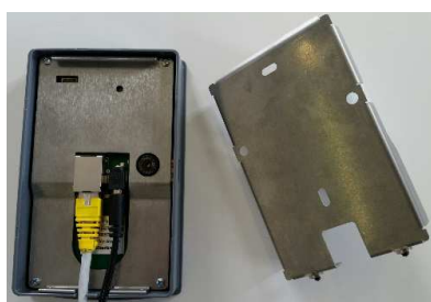
Figura 9b Collegamento della presa e del cavo LAN dietro l'apparecchio.
