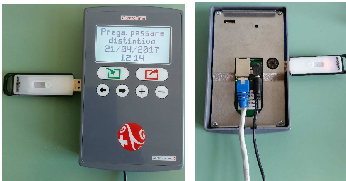
Figura 16 : Foto che ritrae l'inserimento di una chiavetta USB nel marcatempo
