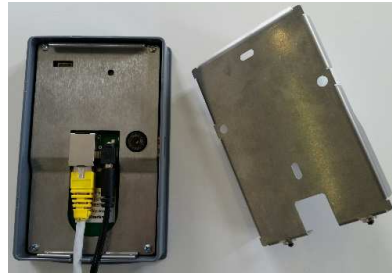
Figura 10b Collegamento della presa e del cavo LAN dietro l'apparecchio.
