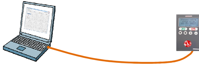
Figura 10a : Schema di collegamento di un marcatempo direttamente al PC
