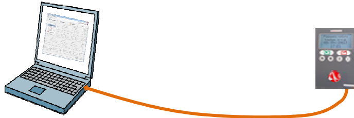
Figure 10 : Schéma de connexion d'une pointeuse directement à un PC
