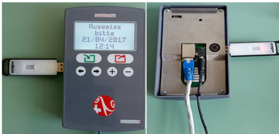
Abbildung 16: Anschluss eines USB-Sticks an das Zeiterfassungsgerät
