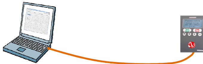
Abbildung 10a : Schema der direkten Verbindung eines Zeiterfassungsgeräts mit einem PC
