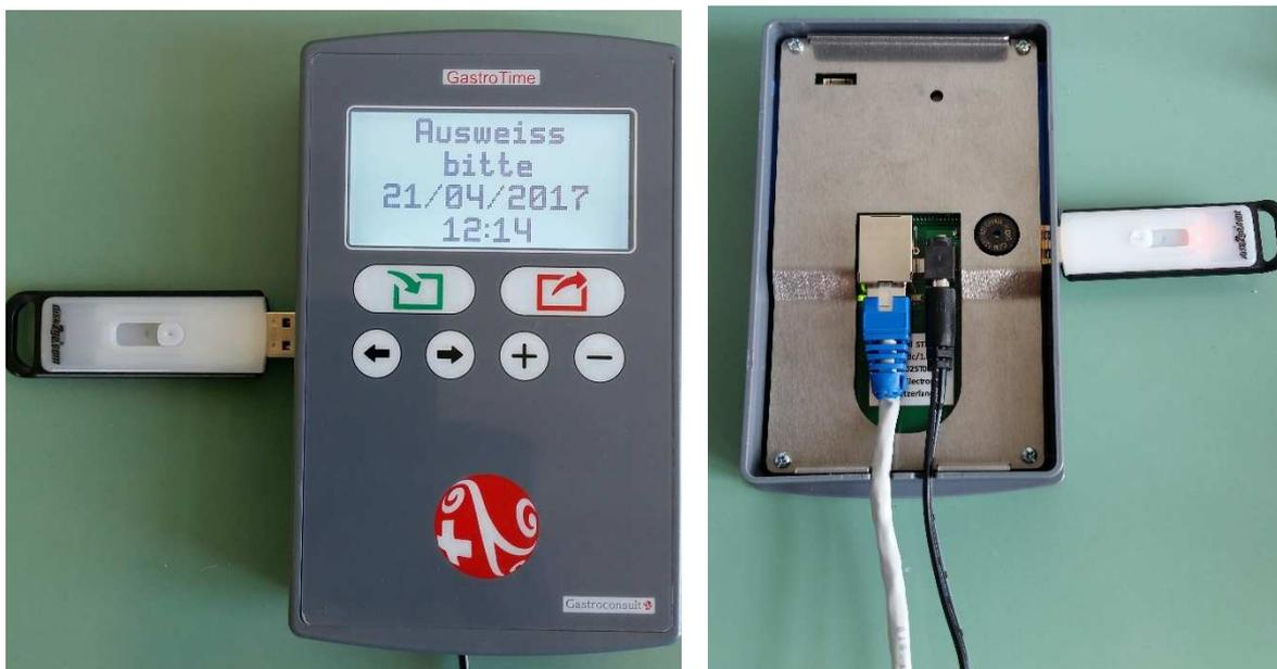
**Abbildung 16** : Anschluss eines USB-Sticks an das Zeiterfassungsgerät
