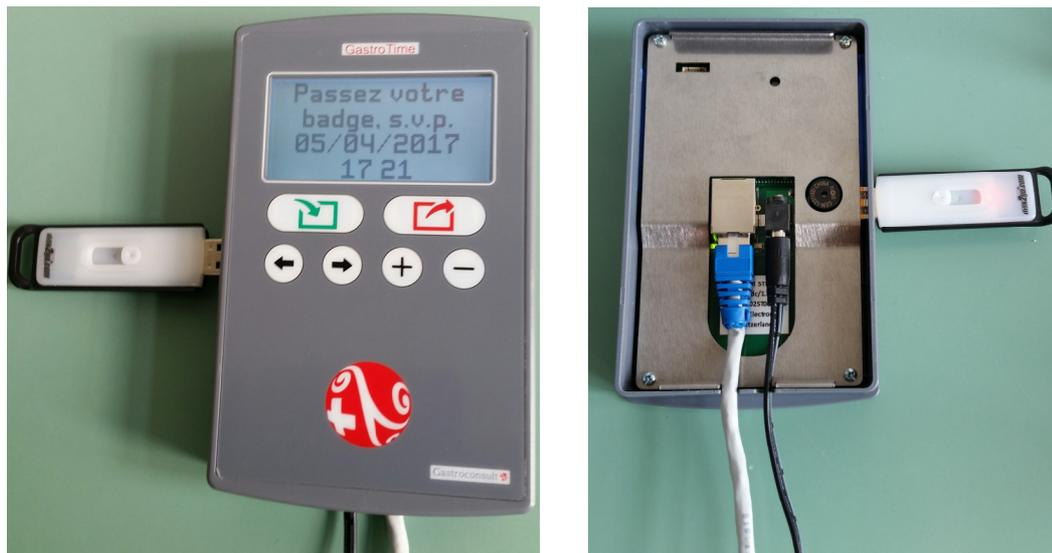
Figure 16 : Photo de l'insertion d'une clé USB dans la pointeuse
