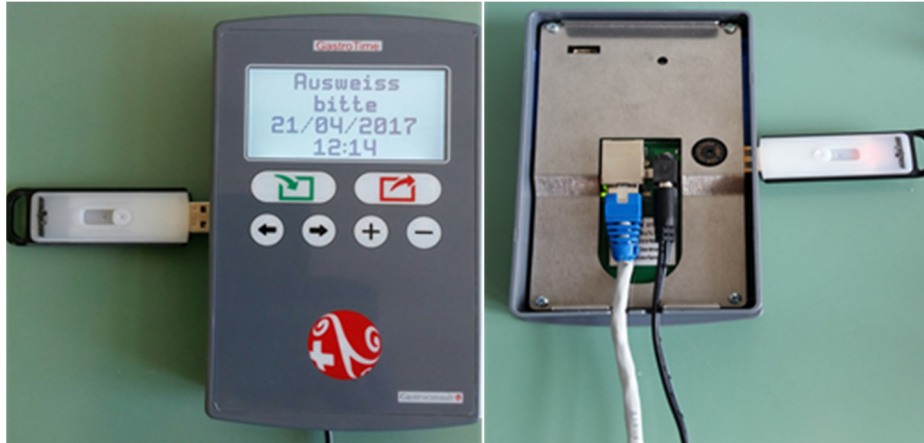
Abbildung 16: Anschluss eines USB-Sticks an das Zeiterfassungsgerät
