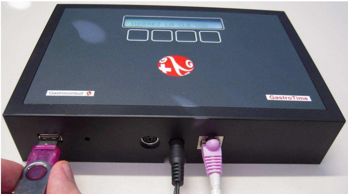
**Abbildung 15** : Anschluss eines USB-Sticks an das Zeiterfassungsgerät
