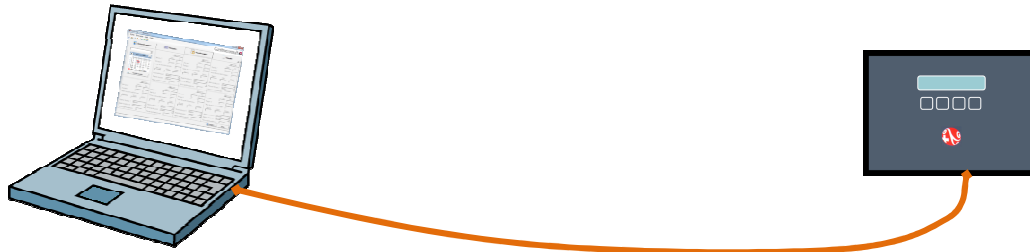
Abbildung 2 : Schema der direkten Verbindung eines Zeiterfassungsgeräts mit einem PC
