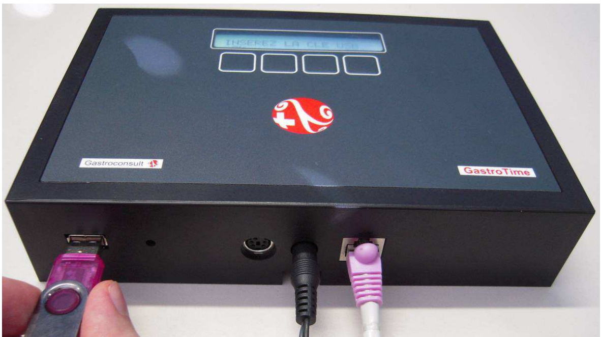
Abbildung 9 : Anschluss eines USB-Sticks an das Zeiterfassungsgerät
