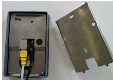
Figure 10b : Raccordement du câble d'alimentation et du câble LAN au dos de l'appareil
