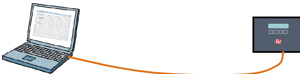
Figura 10 : Schema di collegamento di un marcatempo direttamente al PC
