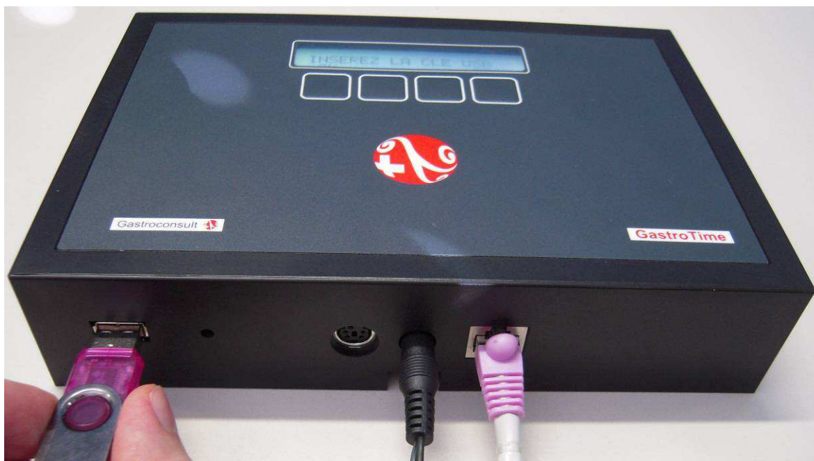
Figura 15 : Foto che ritrae l'inserimento di una chiavetta USB nel marcatempo
